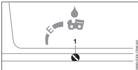
Lorsque la vis de réglage de débit d'huile (1) se trouve en position E (Ematic), le réglage du débit d'huile est optimal pour la plupart des travaux.
